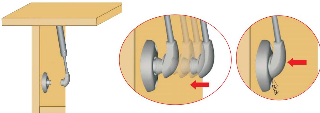
Установка лифтов COMPACT производится без инструментов
